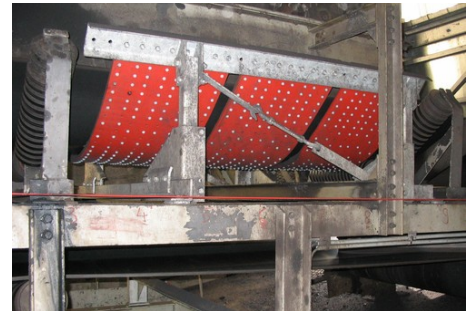
Porto -carbone-, 3200 T/h, nastro da 1600, velocità 3,2 m/sec
